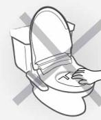
拆卸產品時，請務必先拔除電源插頭
