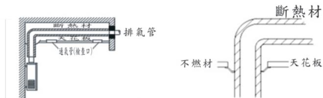
• 排氣管穿透可燃材時之間隔距離
