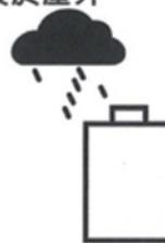
因本機台為屋內設置型，如果安裝場所有淋雨現象，請做遮雨設施，以確保機器能正常使用。另，屋內設置型不可裝設在浴室内。
