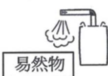
热水器及排氣管附近請勿放置石油、汽油等起火物品及易燃物。另，噴霧罐遇熱時，罐內之壓力會上升，有爆炸之可能。
