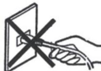
請勿用力拉扯電源線將電源插頭拔除，
