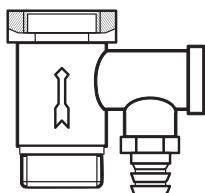
請接軟管排放至排水孔，以免壓力過大洩壓時造成熱水四溢及蒸氣傷人。
