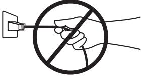
請勿用力拉扯電源線將電源插頭拔除，否則會斷線造成高溫和著火之原因。
